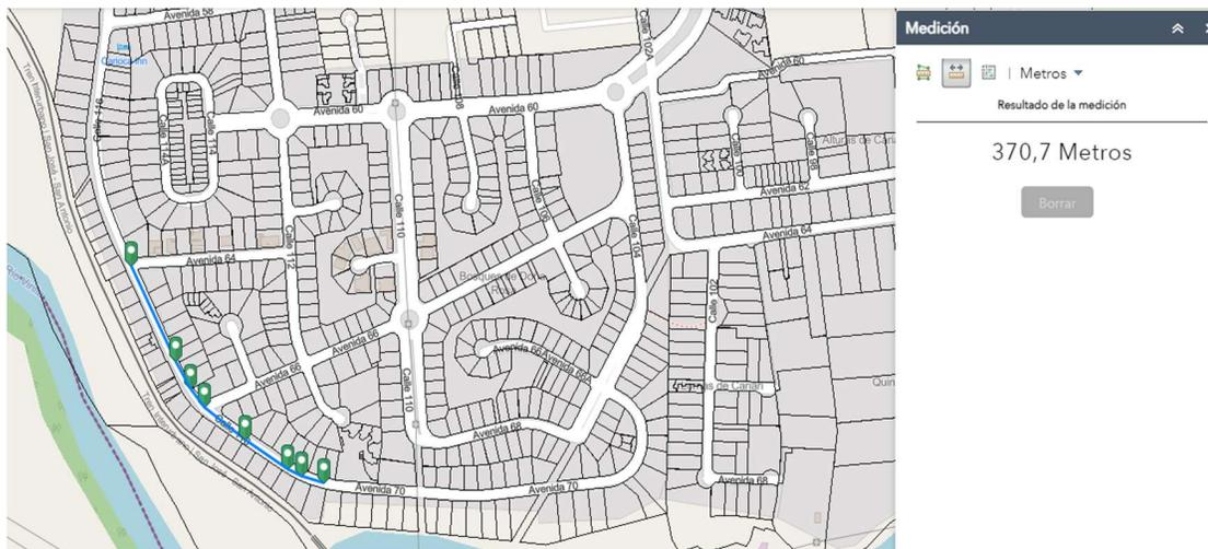
IMAGEN N°2: TUBERÍA PARA UNIFICAR PUNTOS DE VERTIDOS
