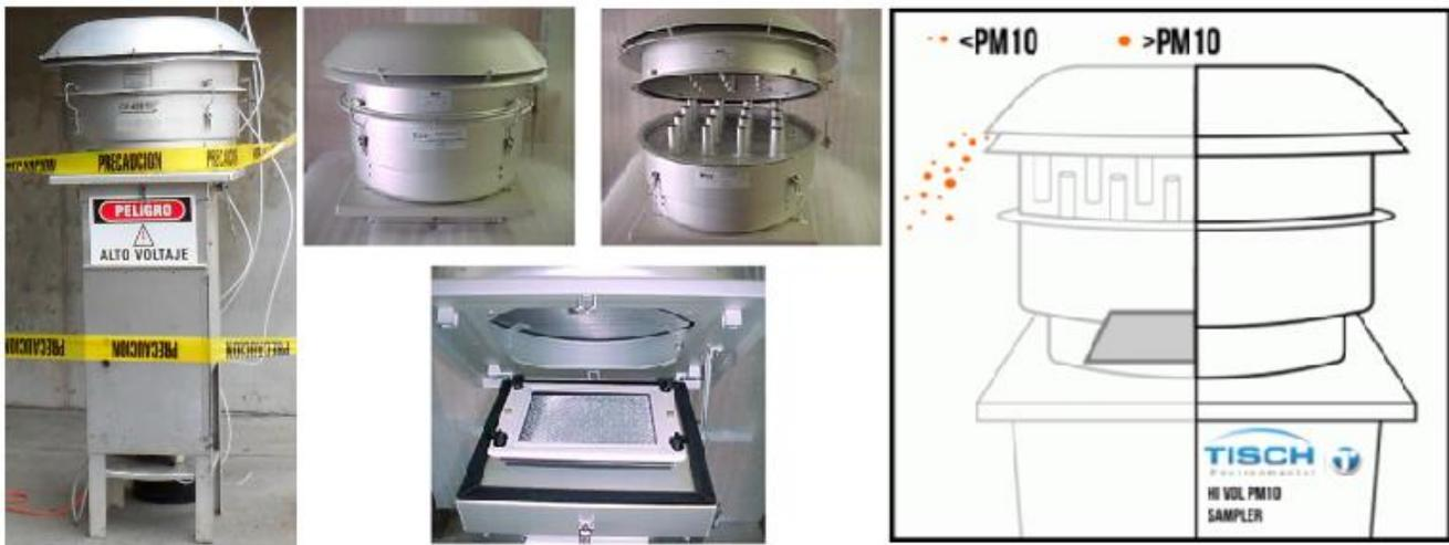
**Figura 3. Diagrama esquemático de un muestreador de alto volumen para la determinación de partículas PM-10**
