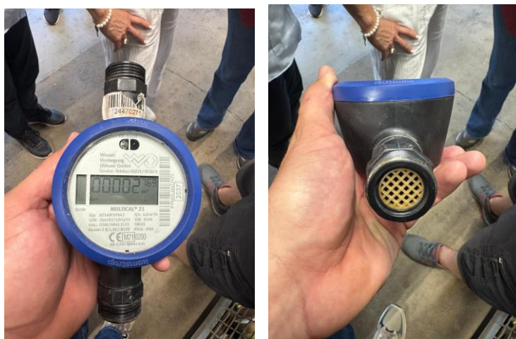
Fotografías 15 y 16. Medidor ultrasónico para micromedición.
