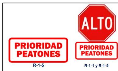
**Figura 65. Señal de prioridad peatonal y ensamble con la señal de Alto**
