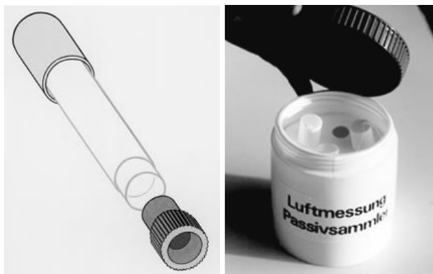
Figura 3. Esquema del colector pasivo para la determinación de dióxido de nitrógeno
