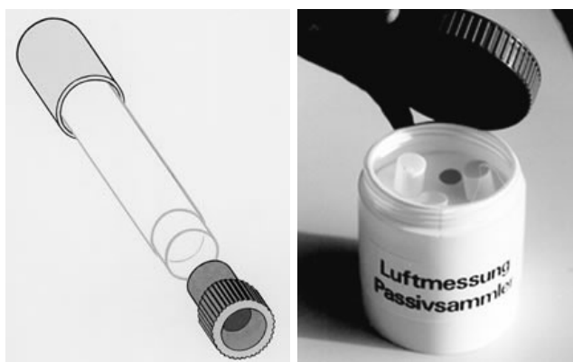
Figura 4. Esquema del colector pasivo para la determinación de dióxido de nitrógeno
