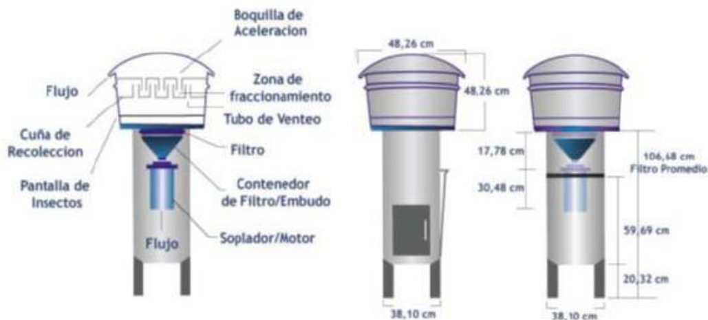
Figura 1. Esquema de un muestreador de aire de alto volumen empleado en la colección de partículas PM 10 . Fuente: http://www.scielo.org.co
