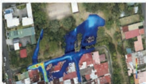
Modelo Hidrodinámico altura del agua se observa alturas máximas de por encima de 0,15 mts por encima del de la superficie generando encharcamiento en calada y arrastre de material. Fuente: propia, 2022.
